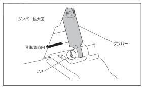
ダンパー装着車はダンパーをツメから引き抜き、グローブ ボックスを取りはずしてください。
