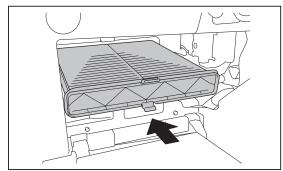
ボッシュ エアコンフィルターを「AIR FLOWの矢印」が 下を向くよう挿入してください。
