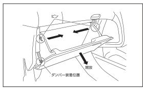
グローブボックスを開き、両側から押さえてピン(2個 所)をはずし、グローブボックスを取りはずしてください。
